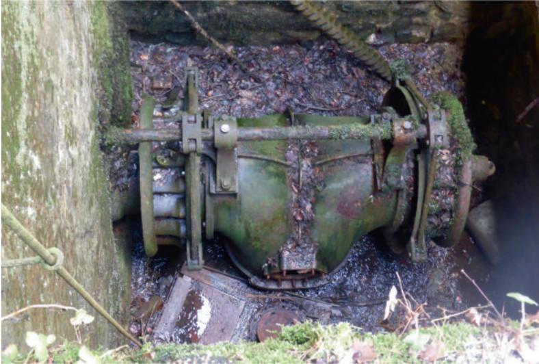
Abb. 10: Eine der beiden Turbinen N= 215min<sup>1</sup> 218 PS<sup>1</sup> für den Antrieb der Schleifer.
