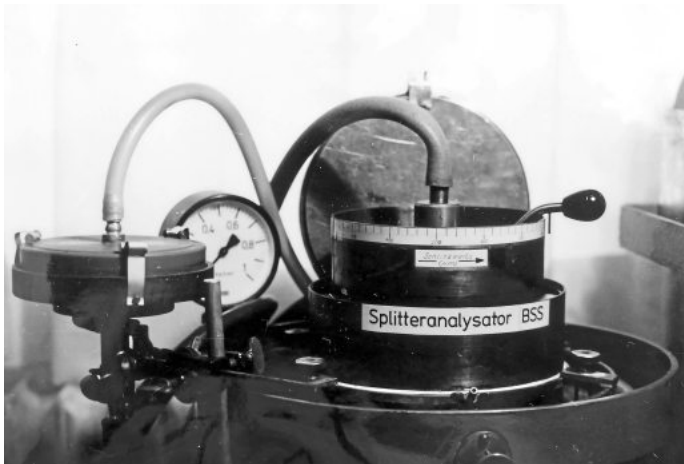
Abb. 9: Splitteranalysator BSS nach Blechschmidt und Steinert an der TU Dresden (1982). 51
