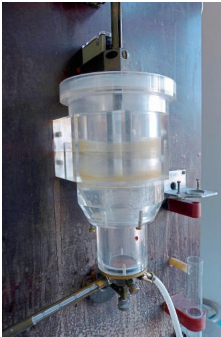
Abb. 8: Messgerät zur Bestimmung der Permeabilität von komprimierten Faserstoffkuchen an der TU Dresden (1985).
