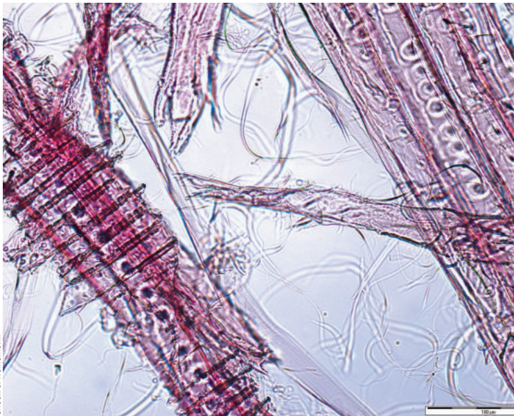
Holzschliff Fasern nach Anfärbung mit Phloroglucin.
