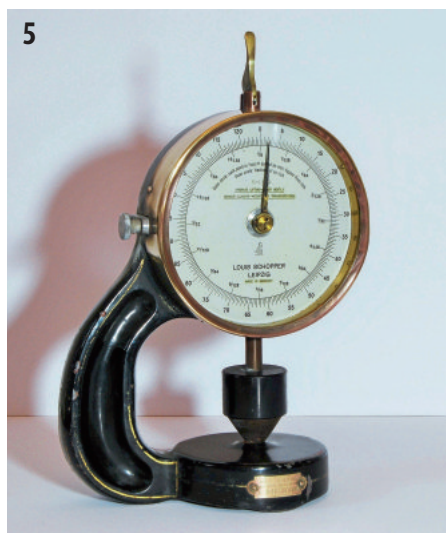
Abb. 3: Prüfgeräte für die Festigkeitsbewertung
