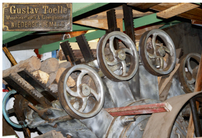
Abb. 6: Holzschleifer von Gustav Toelle (Vortrieb der Pressen mittels Zahnstangen) Baujahr 1895 Heutiger Standort: Museum „Holzschleiferei Weigel“ Rittersgrün
